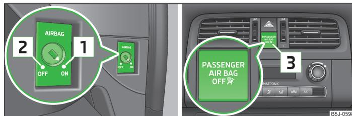
Fig. 119 Conmutador de llave para el airbag frontal del acompañante / testigo de control para la conexión/desconexión del airbag frontal del acompañante
