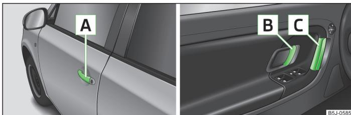
Fig. 11 Tirador/palanca de apertura de la puerta
