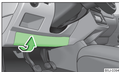
Fig. 150 Parte inferior del cuadro de interruptores: Tapa de la caja de fusibles
