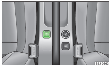
Fig. 134 Tecla para ajustar el valor de control de la presión de los neumáticos
