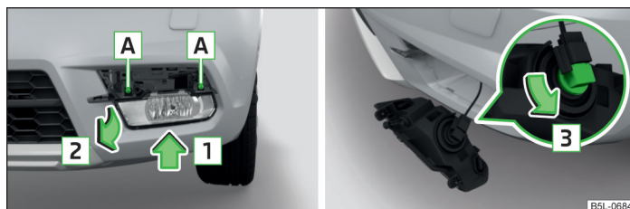
Fig. 200 Imagen esquemática: Desmontar el faro antiniebla / Cambiar la bombilla
