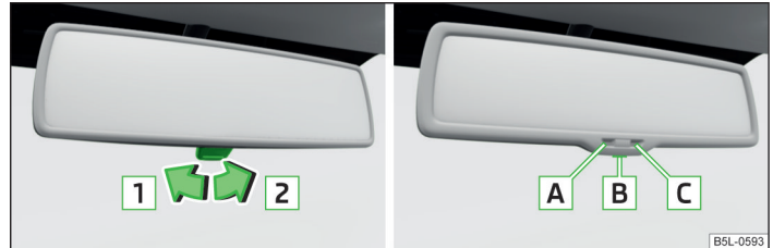
Fig. 37 Retrovisor interior: antideslumbrante manual/antideslumbrante automático
