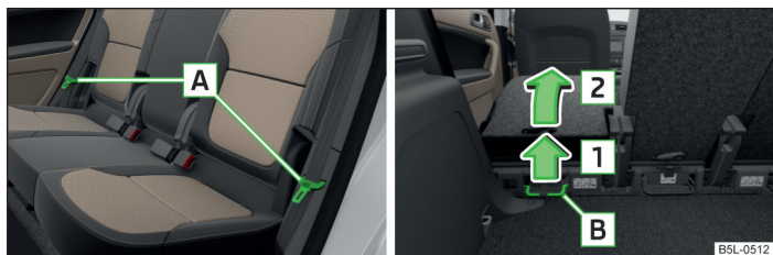
Fig. 50 Posición de seguridad del cinturón / abatir completamente el asiento
