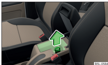
Fig. 67 Abrir la entrada de aire
