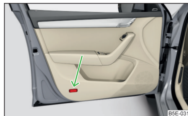
Fig. 59 Front door warning light
