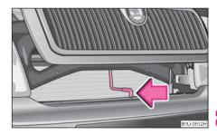
Fig. 15 Radiator grille: Locking lever
